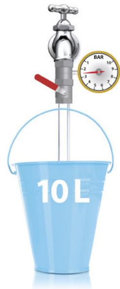
$$\frac{\text{Capacidade (litros)}}{\text{Tempo (segundos)}} \times 3,6 = \text{caudal em m}^3/\text{h}$$
