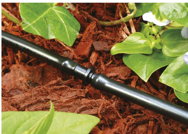
**2** Se necessário, use o cortador de tubulação para cortar esse tubo e as conexões ranhuradas ou de compressão para emendar outro tubo de distribuição.
